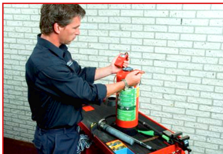
6 Controleren binnenkant van de brandblusser middels doormeten
