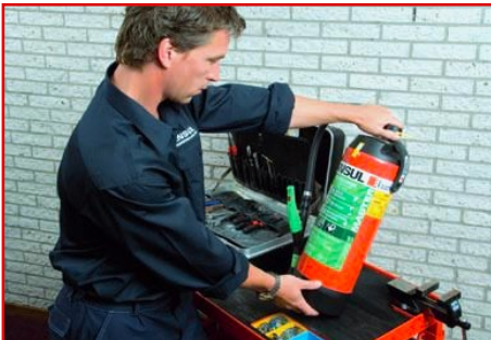
2 Controle leesbaarheid transfer en vaststellen leeftijd van brandblusser
