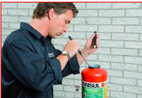
5 Controleren binnenkant van de brandblusser door visuele inspectie
