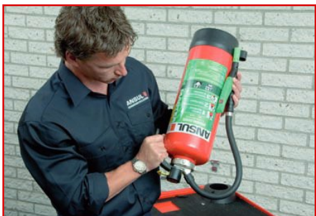
13 Brandblusser controleren op lekkage
